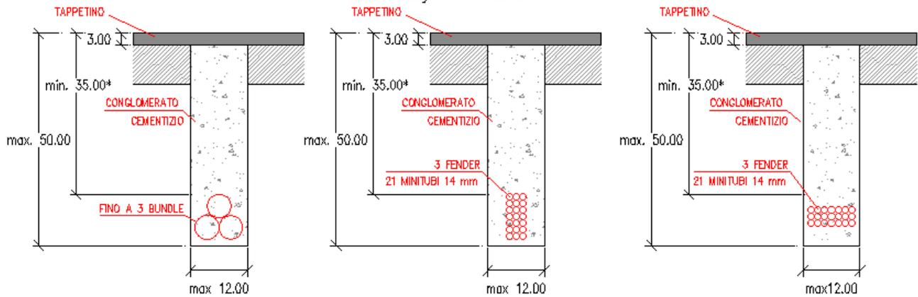
\*La quota altimetrica del ricoprimento della struttura di contenimento dell'infrastruttura digitale è pari a:
