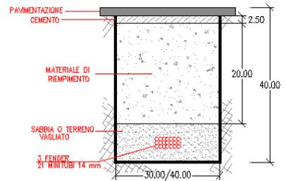
**SEZIONE TIPO SCAVO IN ASFALTO IN MINITRINCEA**
